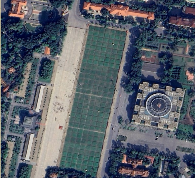
Ảnh viễn thám quang học Pleiades Neo. Dữ liệu đa phổ - độ phân giải mặt đất 0.3m.
