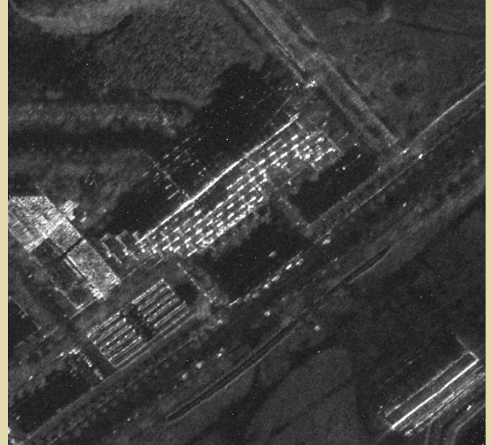
Ảnh viễn thám Radar Capella băng tần X, độ phân giải mặt đất 0.5m.
